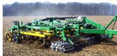
**Ultraflachgrubber:** **Stratos SA 500** Der Stratos schließt die Lücke zwischen Grubber / Pflug und der feinen Saatbettbereitung, auch für Rüben. Durch den hohen Rahmen (max. Durchgang 630 mm) ist die Maschine universell einsetzbar.
